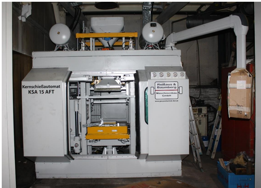
Der Kernschießautomat KSA 15 ersetzt eine 5 Liter-Maschine und kann dank Mehrfachschuss-Option auch mit Kernkästen einer benachbarten 40 Liter-Maschine bestückt werden.
