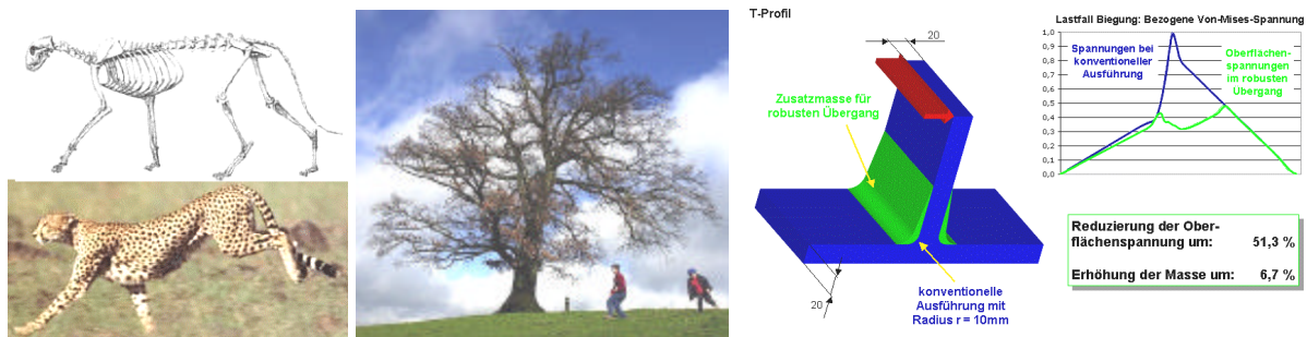
Abbildung 2 Links: Wachstumsvorgänge in der Natur sind Vorbilder der Formoptimierung Rechts: Unter Nutzung der Formoptimierung entwickelte BIOCAST®-Profile werden in h -Konstruktionen quasi als Konfektionsware eingesetzt
