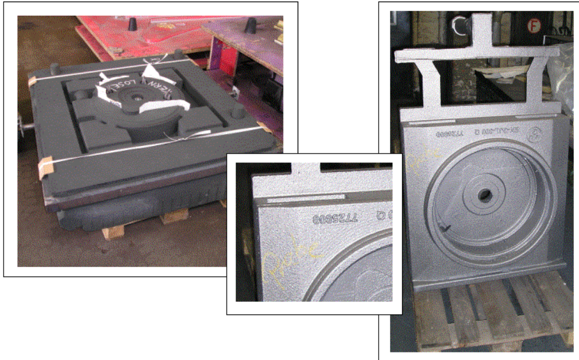
Abbildung 10 Gefräste Sandform (links) für gegossenen Prototypen (rechts)
